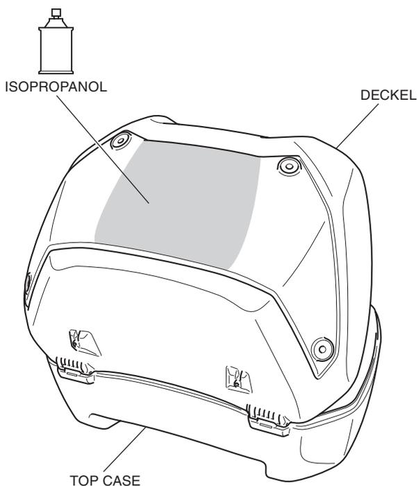
3. Ziehen Sie die Schutzfolie des Klebebands auf der Rückseite der Verkleidung des Top Case-Deckels ab, wie in der Abbildung dargestellt.
