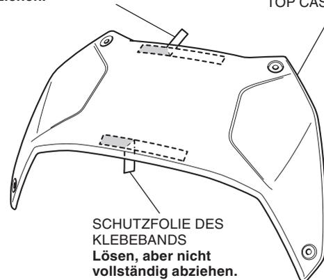
4. Montieren Sie die Verkleidung des Top Case-Deckels, wie in der Abbildung dargestellt.
