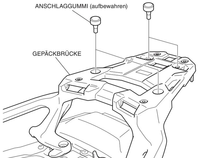
5. Entfernen Sie den Heckgepäckträger wie abgebildet.
