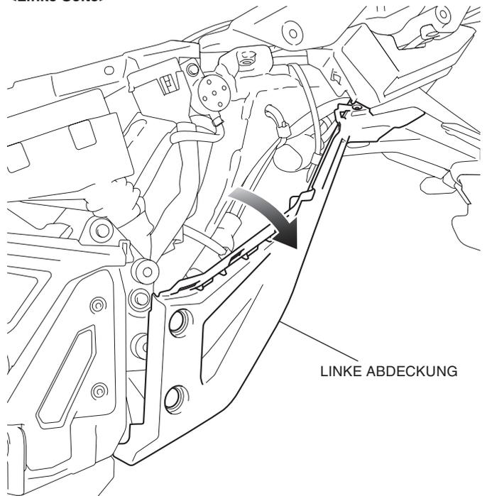
13. Verlegen Sie den Kabelbaum des Deckelöffners, wie in der Abbildung dargestellt.
