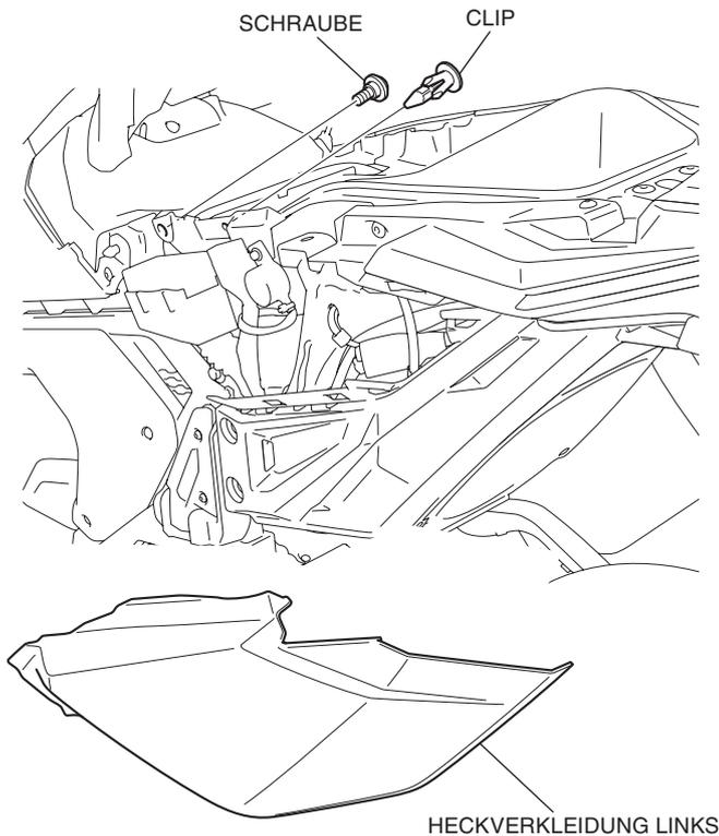
7. Entfernen Sie entsprechend der Abbildung die Schrauben.
