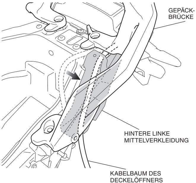
14. Montieren Sie nach dem Verlegen des Kabelbaums des Deckelöffners die Schraube, wie in der Abbildung dargestellt.
