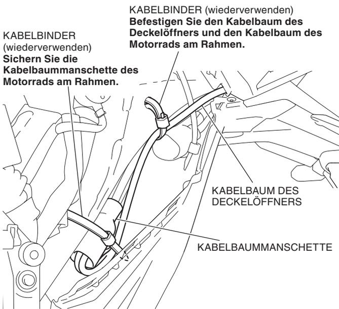
18. Setzen Sie die Teile des Motorrads in der umgekehrten Ausbaureihenfolge ein.
