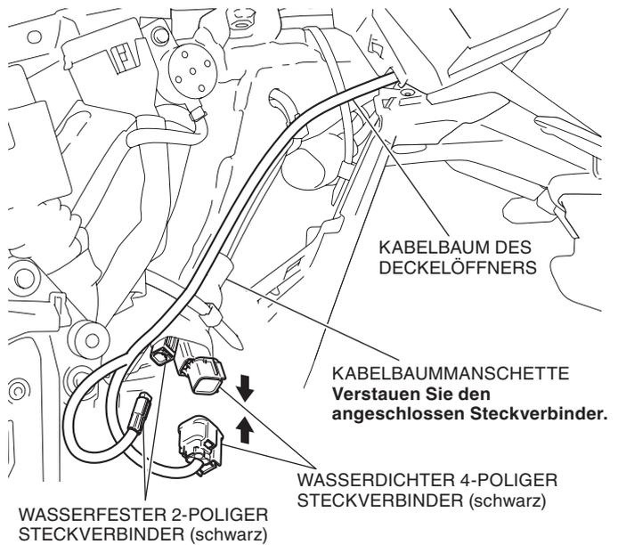
17. Befestigen Sie den Kabelbaum des Deckelöffners mit dem Kabelbinder, wie in der Abbildung dargestellt.
