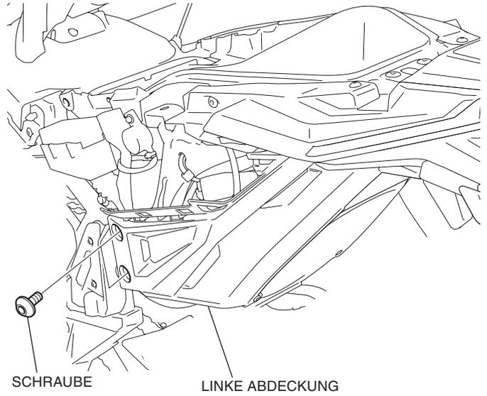
8. Entfernen Sie entsprechend der Abbildung die Schrauben.
