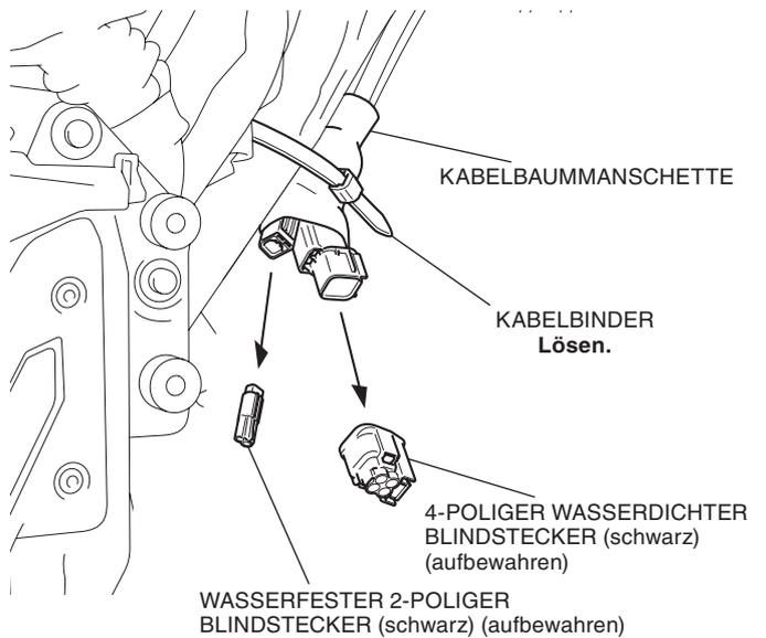
16. Verbinden Sie den Kabelbaum des Deckelöffners, wie in der Abbildung dargestellt.
