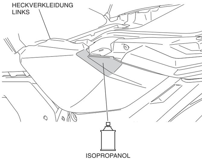
5. Befestigen Sie die Schutzfolien an der linken hinteren Verkleidung, wie in der Abbildung dargestellt.
