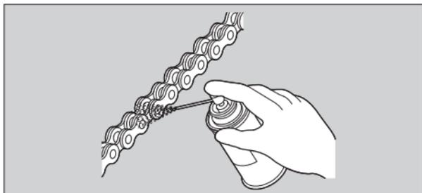
Non utilizzare pulitori a vapore, aspiratori ad alta pressione, spazzole metalliche, solventi volatili quali carburante e benzene, detergenti abrasivi, detergenti per catene o lubrificanti NON specifici per catene con O-ring, poiché potrebbero danneggiare le guarnizioni degli O-ring di gomma. Non versare il lubrificante sui freni o sui pneumatici.
