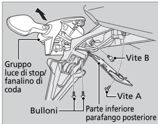
2. Aprire il lato inferiore del parafrangente posteriore.
