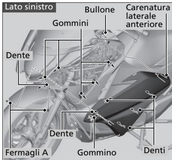
Per la sostituzione delle lampadine dei fari, degli indicatori di direzione e delle luci di posizione è necessario rimuovere le carenature laterali anteriori.
