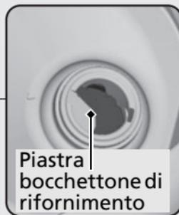
Non rifornire di carburante oltre la piastra del bocchettone di riempimento.
