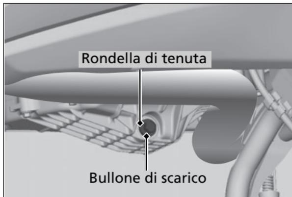
5. Per scaricare l'olio, rimuovere il tappo del bocchettone di riempimento olio/astina di controllo livello, il bullone di scarico e la rondella di tenuta.
