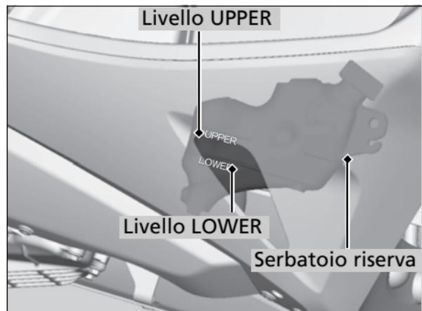
Se il livello del liquido di raffreddamento diminuisce notevolmente o il serbatoio della riserva è vuoto, è probabile che ci siano importanti perdite. Fare controllare la motocicletta presso il concessionario.
