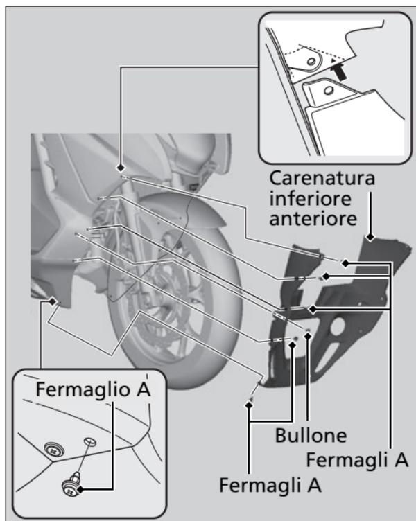
Per eseguire interventi di manutenzione sul serbatoio della riserva del liquido di raffreddamento, è indispensabile rimuovere la carenatura inferiore anteriore e la finitura della pedana destra.
