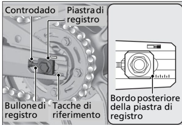
5. Ruotare i bulloni di registro di un uguale numero di giri fino ad ottenere il lasco corretto della catena di trasmissione. Per serrare la catena, ruotare i bulloni di registro in senso antiorario. Ruotare i bulloni di registro in senso orario e spingere la ruota posteriore in avanti per ottenere un lasco maggiore. Registrare il lasco nel punto medio tra l'ingranaggio della ruota anteriore e l'ingranaggio della ruota posteriore. Controllare il lasco della catena di trasmissione. ► P. 86
