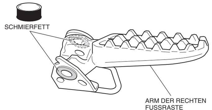
8. Montieren Sie die Rückstellfeder der rechten Fußraste, wie in der Abbildung dargestellt.
