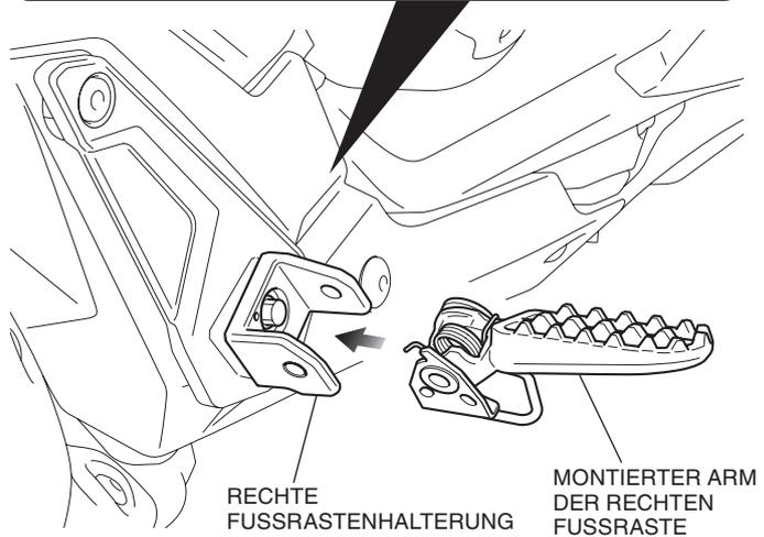
11. Montieren Sie Gelenkzapfen und Sicherungsstift wie in der Abbildung dargestellt.
