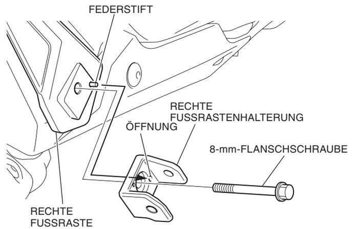
5. Ziehen Sie die lose montierten Schrauben fest.
