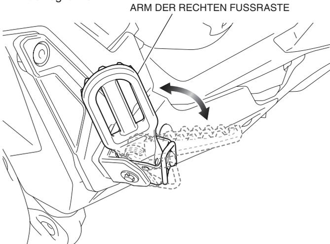
13. Montieren Sie die linke Fußraste, die linke Fußrastenhalterung und den Arm der linken Fußraste auf die gleiche Weise wie auf der rechten Seite.
