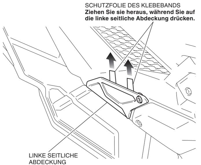
7. Drücken Sie mit angemessenem Druck auf die bereits befestigte linke seitliche Abdeckung.
