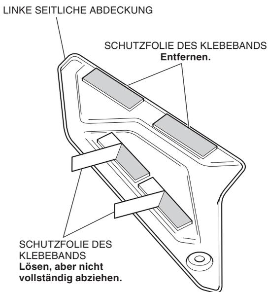
5. Montieren Sie die linke seitliche Abdeckung, wie in der Abbildung dargestellt.
