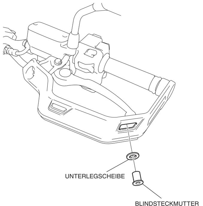
3. Montieren Sie die linke Handgriffschutzblende B wie in der Abbildung dargestellt.
