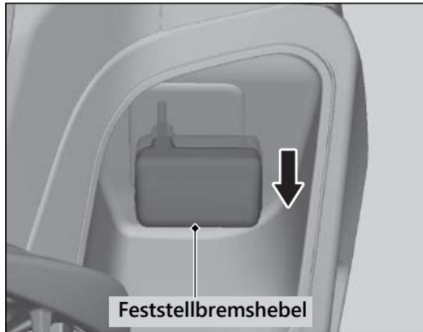
Das Motorrad auf stabilem, ebenem Untergrund abstellen. Zum Überprüfen der Feststellbremse den Motor abstellen, die Feststellbremse anziehen und versuchen, das Motorrad zu schieben.
